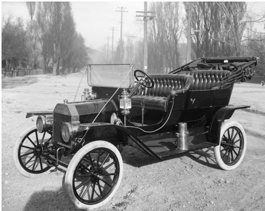
Ford Model T : moteur de 2 900 cm 3 soit 20 CV ; 70 km/h en pointe.
